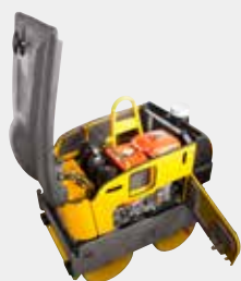
Cubiertas que se abren con un toque para un mantenimiento fácil
