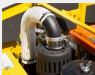
Silenciador con protección contra golpes de ariete
