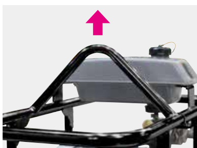
Barra de protección con punto de elevación
